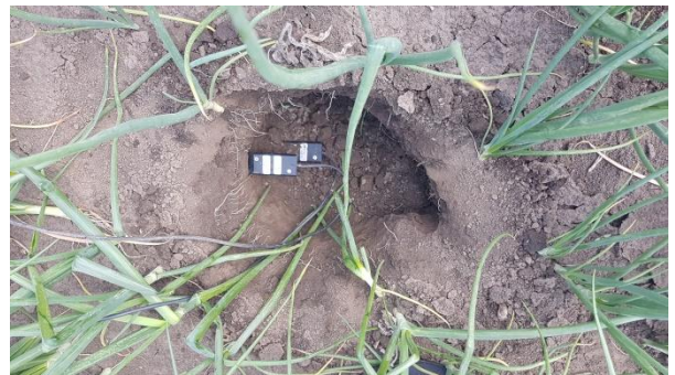
2. ábra SMT100 talajnedvesség szenzorok
